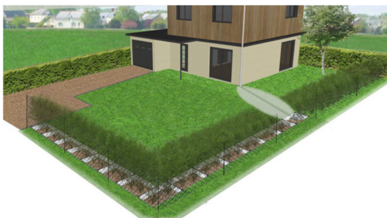
Plan de principe – Gestion des eaux pluviales à la parcelle avec des échelles d'eau Exemple de positionnement des Echelles d'eau
